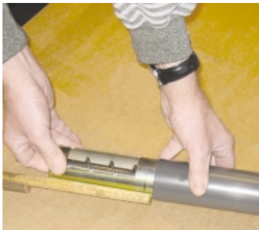
6. Spänn upp 2 mm per meter skruvrör.
