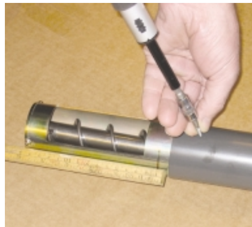
7. Förborra och lås fast med skruv eller använd slangklämma. OBS! Skruven får ej gå igenom intagsdelen med mer än 1 mm.
