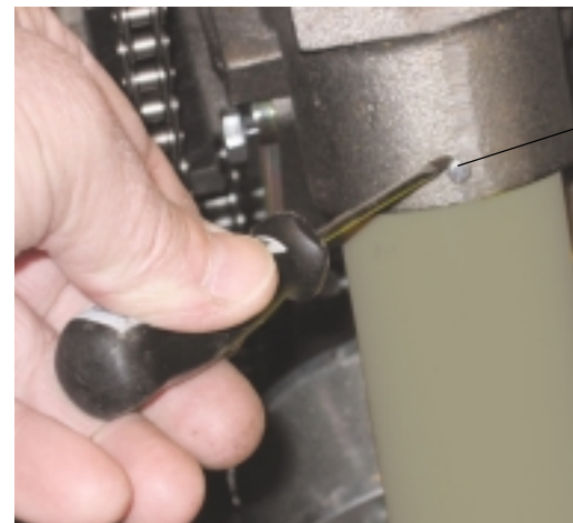
(A) 8. Lås fast rören i varandra med en plåtskruv. Det första röret låses mot växelhuset genom att en plåtskruv sätts i det förborrade hålet (A) på växelhuset.
